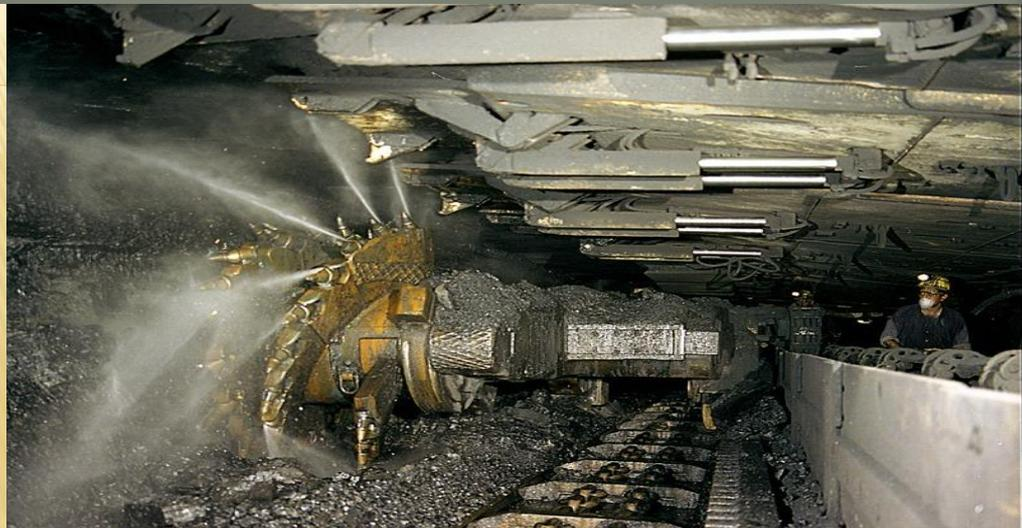
**ГОРНЫЙ КОМБАЙН**, комбинированная машина, производящая разрушение массива горных пород и погрузку их в транспортные средства.
